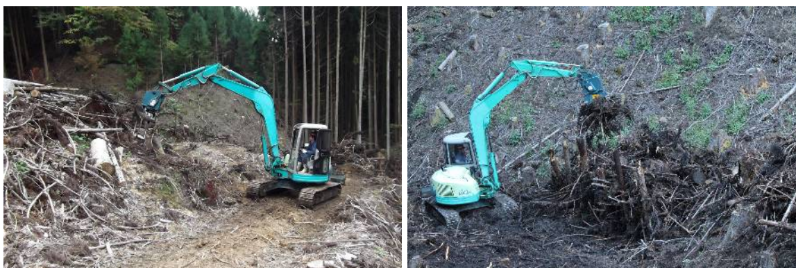
写真2 機械地拵の実施状況 (事例3)
