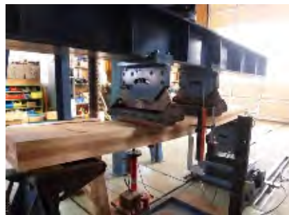
アカマツCLT実大曲げ試験
