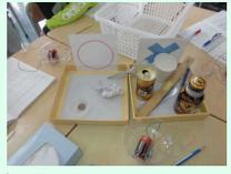
予想では鉄は電気を通すと考えていたが、錆防止のコーティングのため通電せず新たな疑問が生まれた。→やすりで削り再実験へつなげた。
