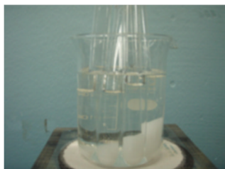
【図1】 80℃のお湯で質量の違う4つの硝酸カリウムを全て溶かします。
