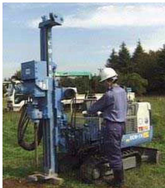
写真-1 土壤試料採取状況
