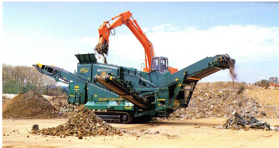
写真-1 二次粒度分組機(重機振動スクリーンの使用例)
