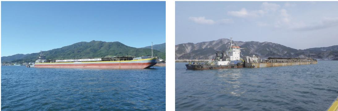
写真 3.6.3 宮古地区、山田地区、大槌地区の海上運搬で使用した 2 船団（3,000 $\text{m}^3$ 積級の土運船と押船）
