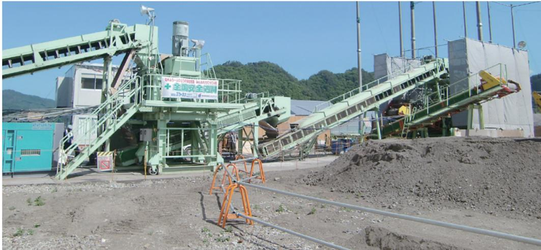
写真 3.5.12 高速回転式破碎混合機
