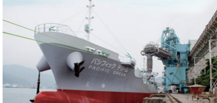
大分工場に接岸する新造船「パシフィック ドリーム」(2014年6月運航開始)。全長約114m、セメント積載量約7,000トン。東北復興や東京オリンピック・パラリンピックのためのセメント輸送も担っています。
