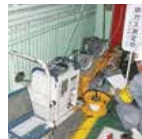
ばい塵測定 法律や自治体との協定の遵守に向けて、定期測定を実施しています。
