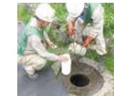
排水の水質測定 規制を受ける成分を定期的に採水して測定しています。
