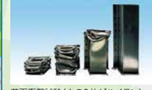
落下衝撃試験(中の2体がハイテン)
