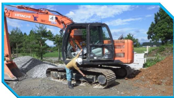
② 油の流出を発見（油圧モーター部を想定）
