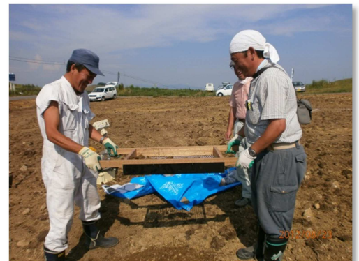
〔写真 4：砕土率を確認した実証試験風景〕
