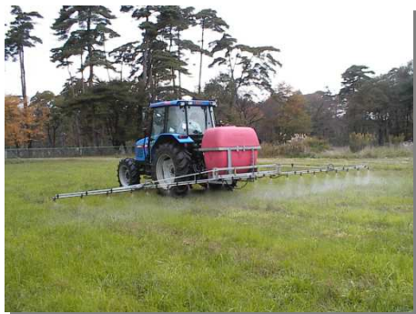
〔写真1: ブームスプレーヤーでの散布〕
