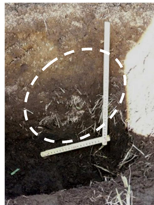
〔写真2：2回目除染を試み土塊の破碎に成功〕
