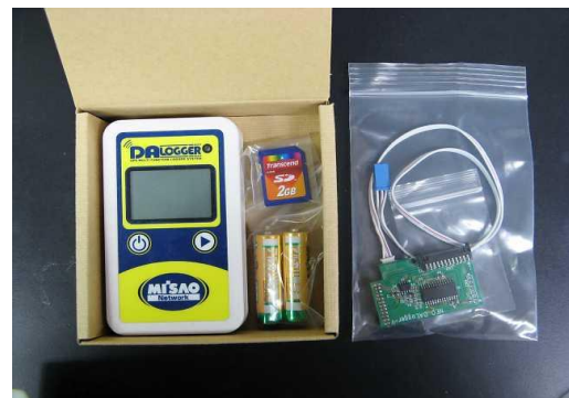
写真 1 DALogger 本体及び付属品 右側: TCS-172B に内蔵させる インターフェイス
