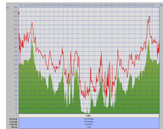
図 5 盛岡からおよそ 100km 走行時(往復)の高度情報比較 (緑色部分: 国土地理院・基盤地図情報の標高値) 上段: DALogger の GPS 高度情報(赤線) 下段: GPS 内蔵スマートフォンの GPS 高度情報(赤線)
