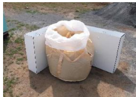
対象を L-box 型枠で囲む
