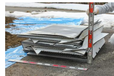
写真 3 解体後の L-box の物量(M サイズ 1 組 2 個分)
