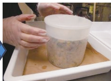
③測定容器に測定試料を詰めます。
