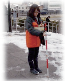
サーベイメータによる空間線量率測定の様子（生活空間）
