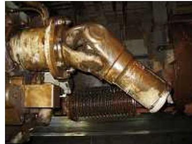
車両（推進軸脱落）
