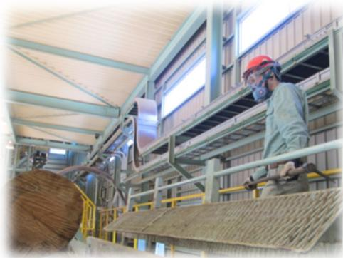
釜石のシンボルとも言える製鐵所の煙ですが、今は製鐵のための煙ではなく、火力発電のための水蒸気です。その燃料の約1割は、地元の森林を間伐した丸太です。見学では、破碎工場で丸太が瞬く間にチップになる様子が見られます。
