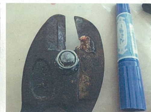
〔救援活動に際し、垂下った電力ケーブルを切断した時に融解したケーブルカッターの刃先: 熊本地震の例〕
